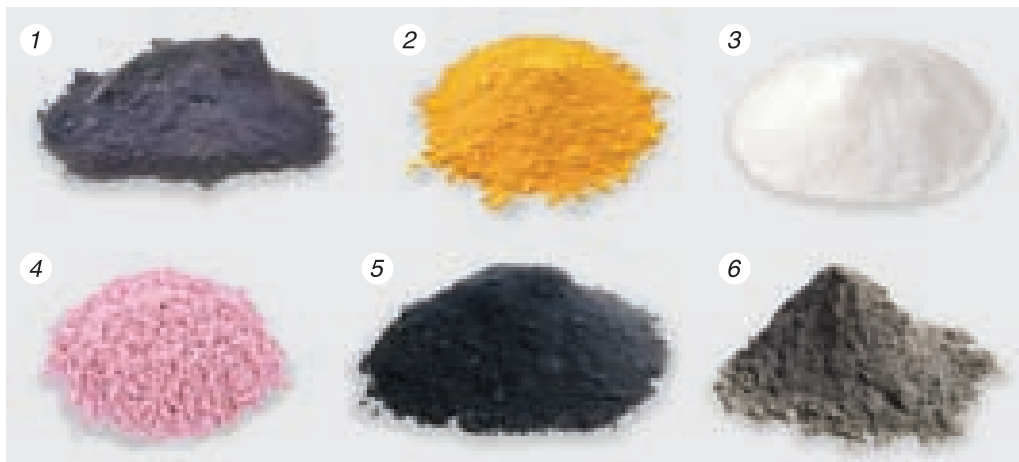
Рис. 56. Окраска сульфидов некоторых металлов: 1 — сульфид свинца(II), 2 — сульфид кадмия, 3 — сульфид цинка, 4 — сульфид марганца(II), 5 — сульфид меди(II), 6 — сульфид никеля(II)
