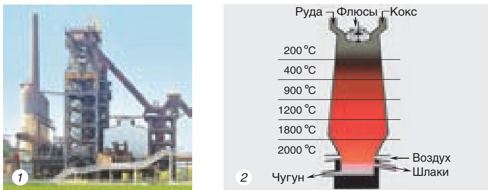
Рис. 157. Доменная печь: внешний вид (1) и схема устройства (2)
