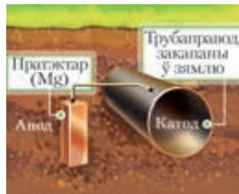
Мал. 116. Ахова ад карозіі падземнага стальнага трубаправода
