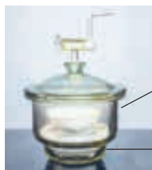
Мал. 86. Эскіатары для захоўвання і сушэння гіграскапічных рэчываў
