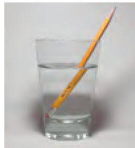
Рис. 129. Преломление света на границе раздела двух сред
