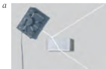
Рис. 138. а — световой луч, проходящий через плоскопараллельную пластинку; б — ход луча в пластинке
