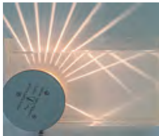
Рис. 133. Полное отражение света на границе раздела сред
