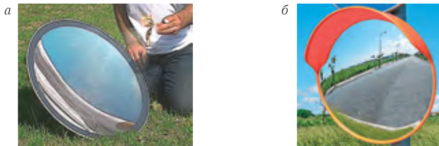
Рис. 112. Сферические зеркала: a — вогнутое; б — выпуклое
