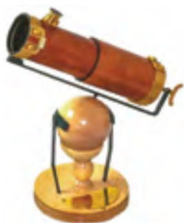
Рис. 121. Телескоп-рефлектор Ньютона и ход лучей в нем
