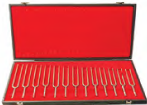
Рис. 46. Камертоны с частотами колебаний звуков первой октавы
